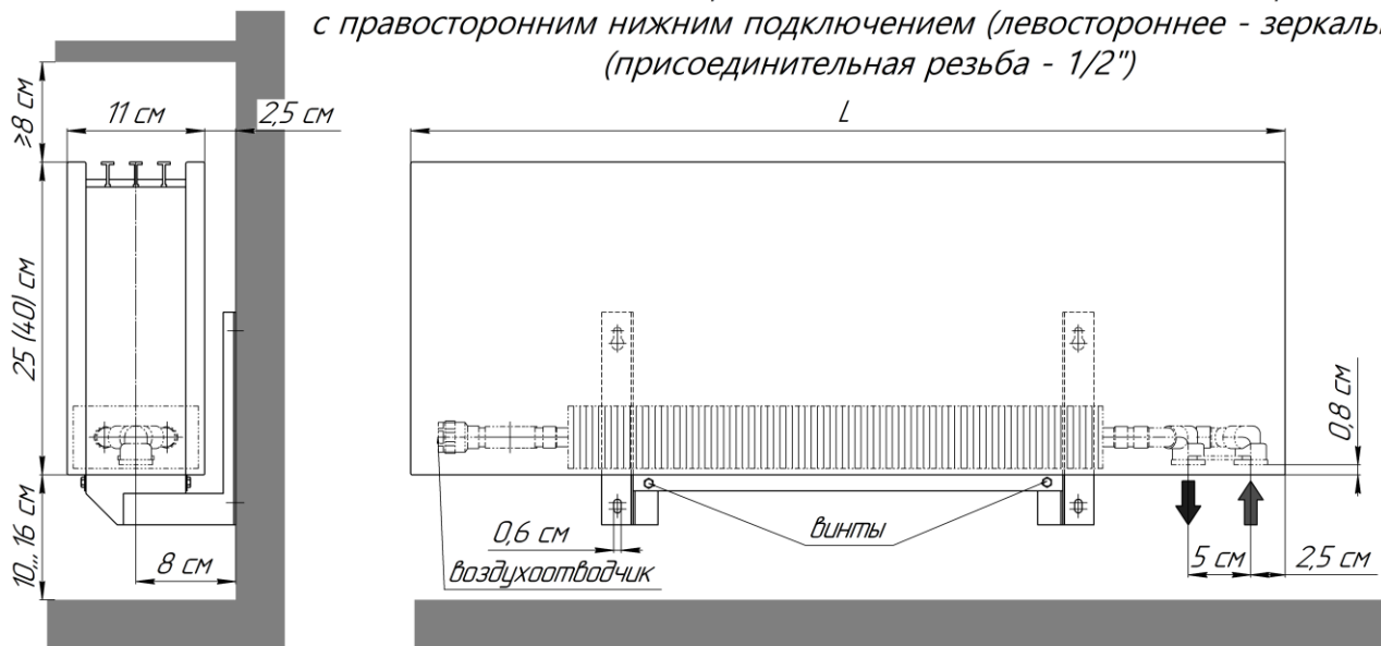
Настенный конвектор "Эlegant 110x250 (400) -1то Терм Стен прав" с правосторонним нижним подключением (левостороннее - зеркально) и встроенным термоклапаном (присоединительная резьба - 1/2")
